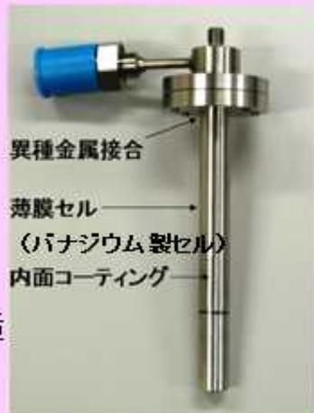
水素貯蔵材料構造解析用耐圧セル
