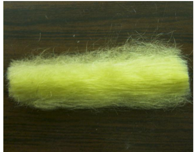
チタンアルコキシド由来のポリチタノキサンから 得られた透明なチタニア繊維(窒素ドーピング型)
